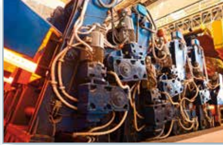
8 Тянуще-правильное устройство Комбинированный Конический G + Соосный E + Мотор TX
