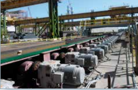
1 Рольганг на входе в печь Соосный серия E + Мотор серия S
