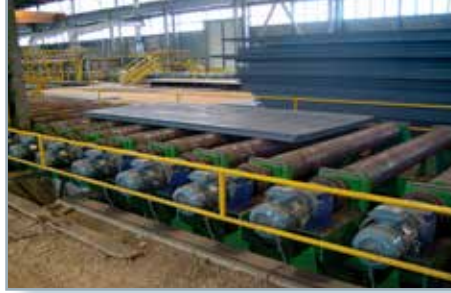
7 Охлаждающий рольганг Цилиндрический G или Конический EP + Мотор TX
