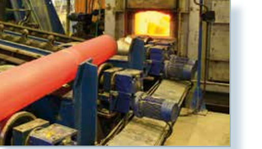
12 Прокатный стан бесшовных труб Цилиндрический G или Конический EP + Мотор TX
