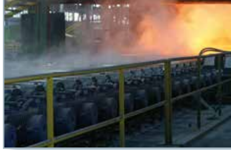
4 Входной рольганг обжимного стана Соосный серия E + Мотор серия S
