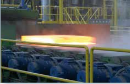
3 Рольганг на выходе из печи Соосный серия E + Мотор серия S
