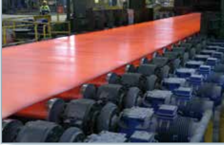
5 Выходной рольганг обжимного стана Соосный серия E + Мотор серия S
