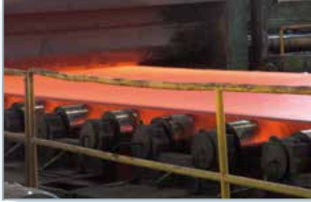
6 Рольганг горячей правки Цилиндрический G или Конический EP + Мотор TX
